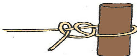
Nodo d'Ormeggio (nodo di avvolgimento)
